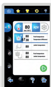
POKROČILÉ řízení podle přesné teploty pokrmu a pláště kotle i jejich teplotního rozdílu.
